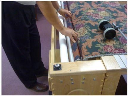
FLIPPED AND TUCKED FABRIC RESTING ON BACK TWO ROLLERS.
