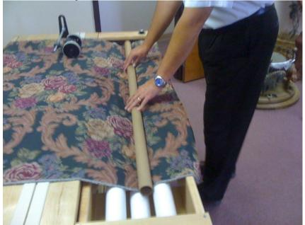
**Step 6**FLIP FABRIC OVER TUBE & TUCK UNDER. BE SURE TUBE IS RESTING ON BACK TWO ROLLERS OF PULL TABLE.
